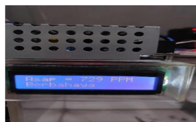
Gambar 11 LCD status diatas 300 ppm Berbahaya Fan menyala 4
