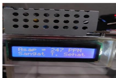
Gambar 10 LCD status diatas 200 ppm Sangat Tidak Sehat Fan menyala 3
