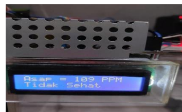
Gambar 9 LCD status diatas 101 ppm Tidak Sehat Fan menyala 2
