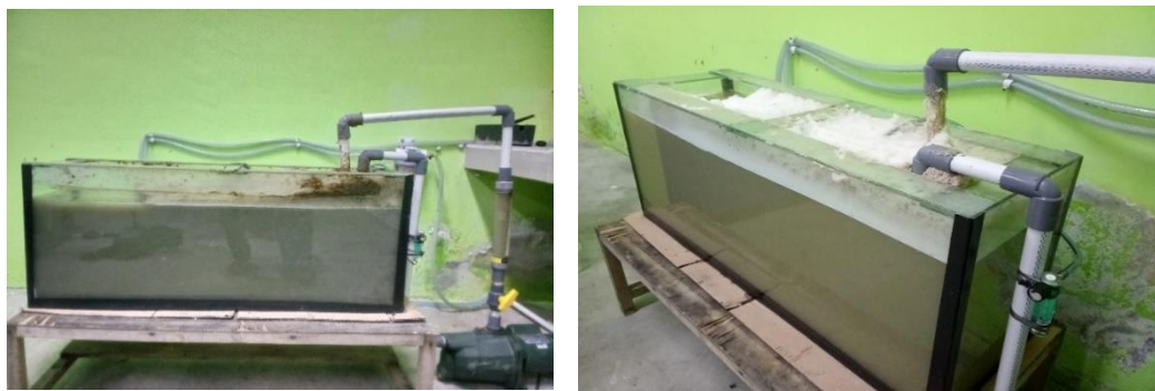
Gambar 6. Percobaan microbubble generator pada air limbah
